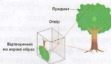
Рис. 2. Принцип дії камери-обскура
