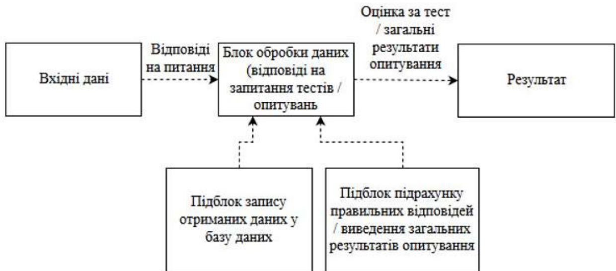
Рис. 1.8 – Загальна модель структури проєктного web-додатку для дистанційного тестування на знання точних і природничих наук
