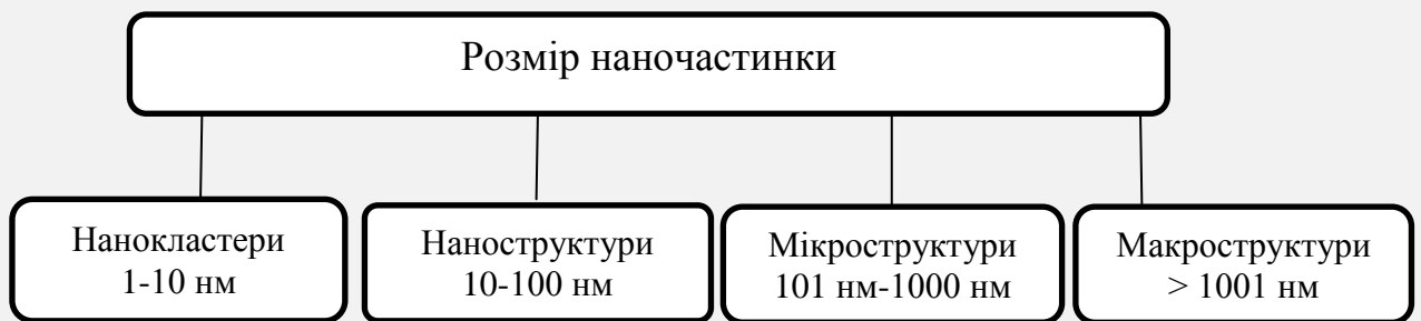
Рис. 8. Класифікація наночастинок за розміром
