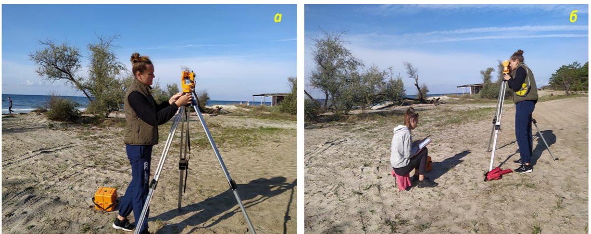
Рисунок 2.2 – Геоморфологічне профілювання берегової зони за допомогою оптичного нівеліру GEO-FENNEL FAL 32: а – налаштування приладу; б – проведення зйомки (фото А.І. Пилипенко).
