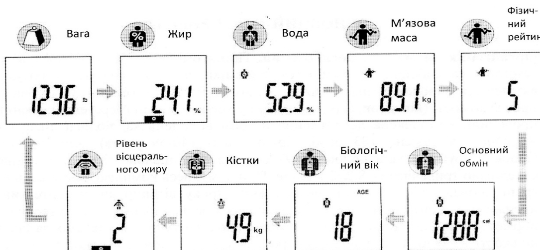
Рис. 24. Функції монітору складу тканин тіла «TANITA»
